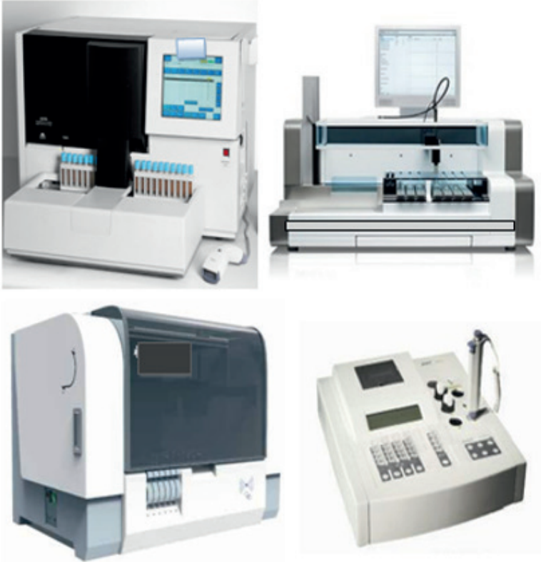
Şekil 4. Laboratuarlarda kullanılan optik ve fotometrik koagülasyon cihazlarına örnekler.
